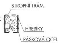
b) zesílení ocelovými příložkami
